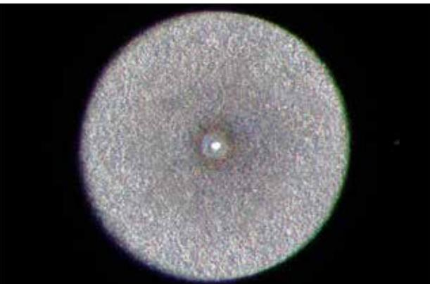
*Ein Testschuss muss ein konzentrisches Muster hinterlassen.*
